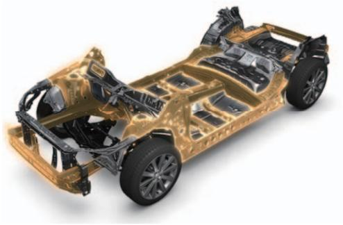
Fig. 4 Subaru Global Platform<sup>(6)</sup>
